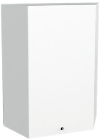
CDZBE(-LAS)-G2 Boîtier d'étage avec ligne avertisseurs sonores et lumineux* Un boîtier d'étage est nécessaire par étage de l'immeuble d'habitation. Le boîtier d'étage gère des déclencheurs manuels, des détecteurs et des trappes de désenfumage à chaque étage. Inclus le module de fin de ligne DAS. *L'option LAS gère les diffuseurs sonores et lumineux qui sont directement raccordés.
