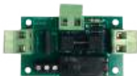
CDBEDAS-R Module de commande de DAS à rupture Ce module nécessite l'utilisation d'une alimentation externe. Ce module est indispensable pour la commande de DAS à rupture ou commande de PCF de recouplement à rupture.
